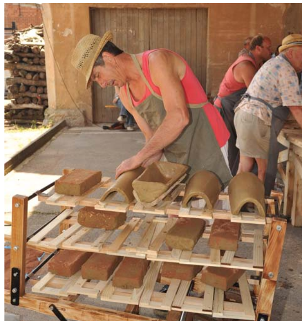
Prikaz ročne izdelave opeke in korcev na prireditvi “Opekarski dan”.
